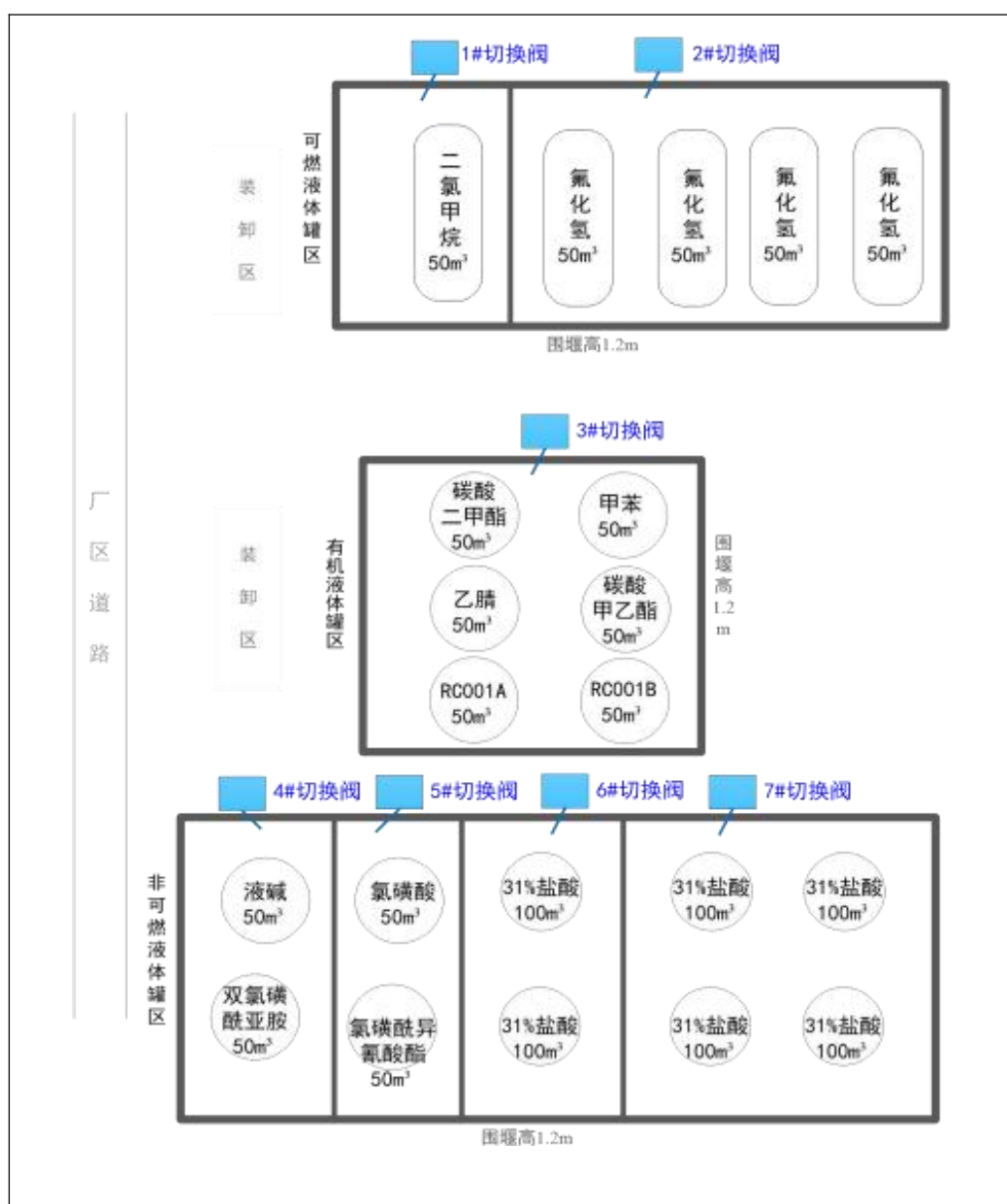
1#南部罐区储罐分布及围堰设置情况（进入 1#事故池）
